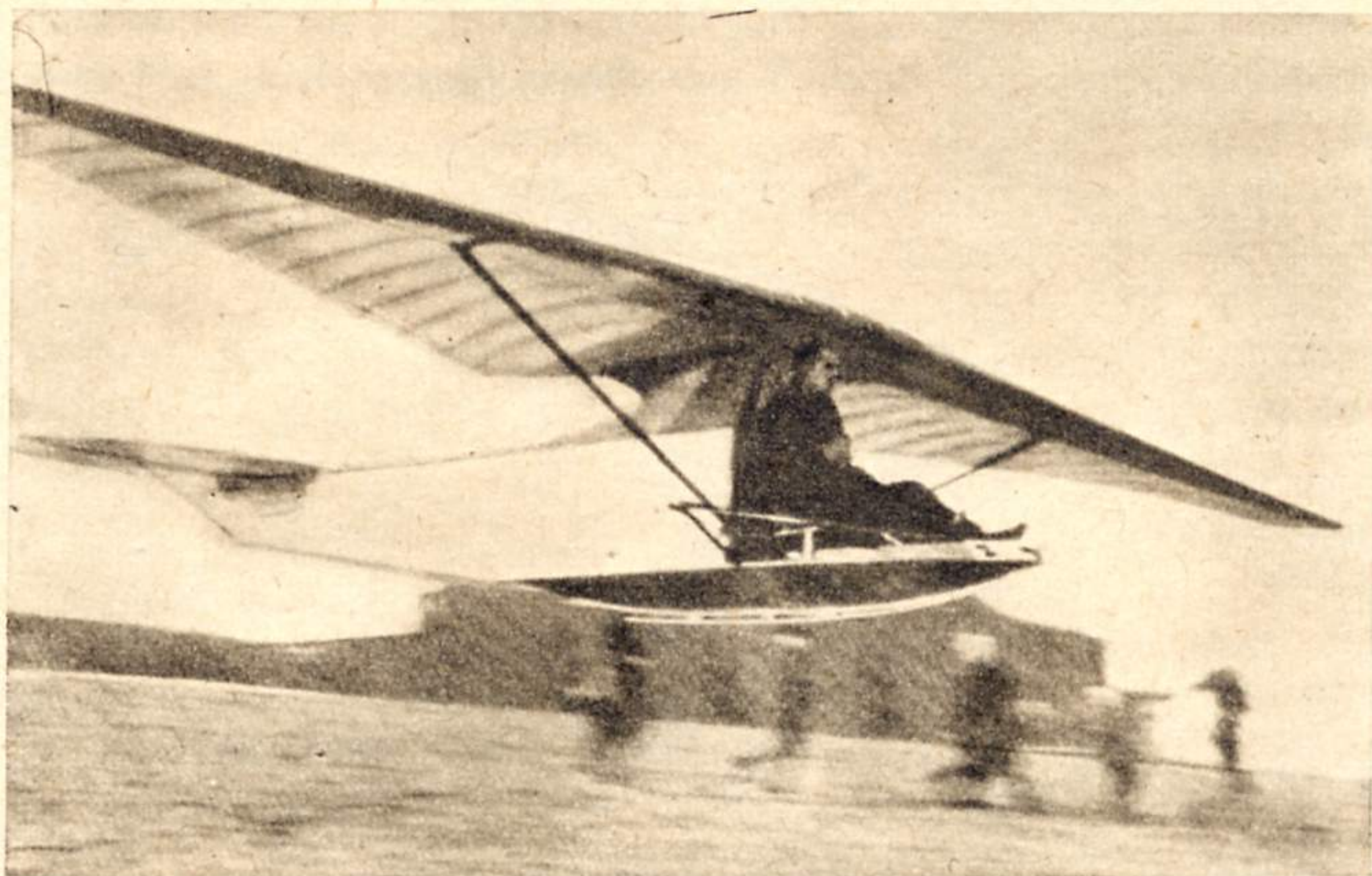
Beim Rhönwettbewerb 1928 gelang dem Segelflieger Dromse am Steuer eines von Stamer und Lippisch entworfenen Schwingenflugzeuges ein kurzer Muskelkraftflug
