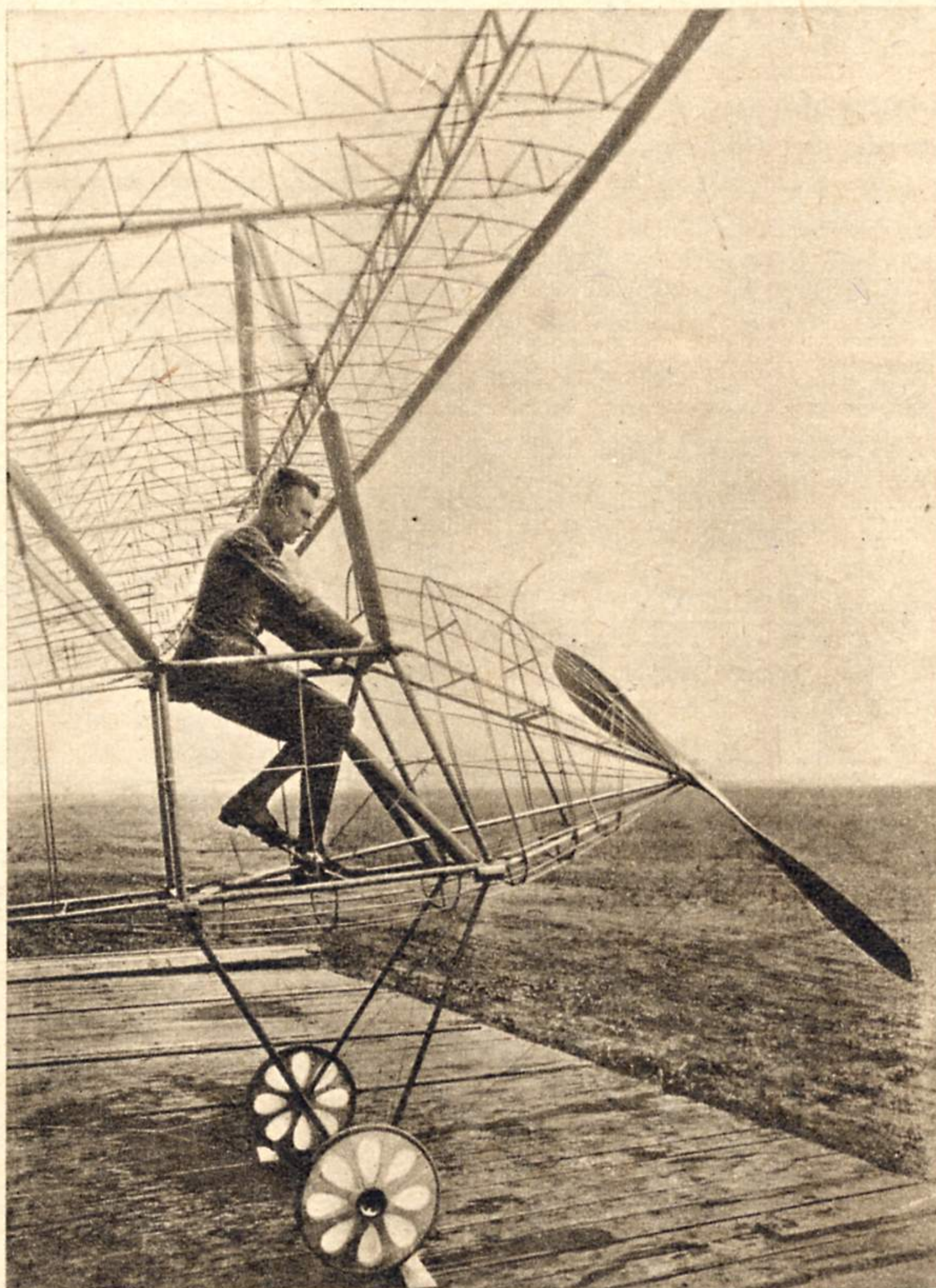
Der deutsche Konstrukteur Georg König baute gegen Ende des Weltkrieges ein Muskelkraftflugzeug, das eine Verfeinerung der großen Motorflugzeuge darstellte. Die Luftschraube wurde über eine Tretkurbel angetrieben. Die Versuche mußten nach Kriegsende abgebrochen werden
